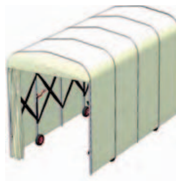
Modèle de sas-tunnel qui sera installé pour la circulation entre les bassins intérieurs et le bassin nordique.
