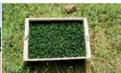
Echantillon de gazon synthétique partiellement sablé et rempli de granulats de caoutchouc emprisonnés par des fibres synthétiques.
